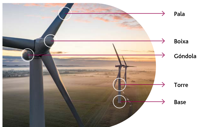
Gràfic 4. - Parts de l'aerogenerador o turbina eòlica. Font: NTP 1022. Aerogeneradors (I): funcionament i marc normatiu de prevenció de riscos laborals.
